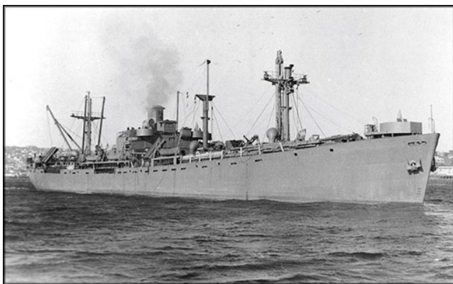
Libertyfartyg. Totalt byggdes mer än 2700 fartyg under andra världskriget. Dimensionerna var L=135 m, B=17 m och D=8,5 m och dödvikten 10 500 ton.
