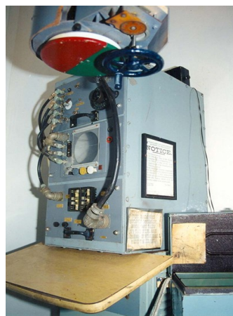
Operatörskonsolens utseende framgår av bilden under. Här syns A-indikatorns placering i mitten av elektronikabinettet och ratten för manuell styrning av antennen i sidled syns tydligt.
