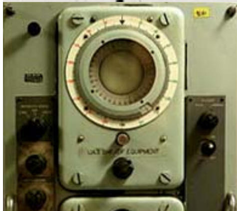
Bilderna visar ett antennarrangemang och en operatörsutrustning för en brittisk fartygsmonterad Huff-Duff. På operatörsutrustningens katodstrålerör presenterades riktningen till en ubåts kortvågssändning.
