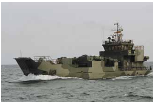
HMS Loke kan göra sitt eget dricksvatten och har en lastkapacitet för drivmedel på cirka 90 kubikmeter diesel. Fartyget kan främst genomföra transporter och försörja förbandsenheter med drivmedel. Dessutom kan fartyget bära funktioner för exempelvis teknisk tjänst, förplägnadstjänst och sjukvård. Foto: Försvarsmakten. Till höger: Personal ur Bastransportplutonen lastar ombord förnödenheter på HMS Loke. Foto: Maja Hansson/Försvarsmakten.
