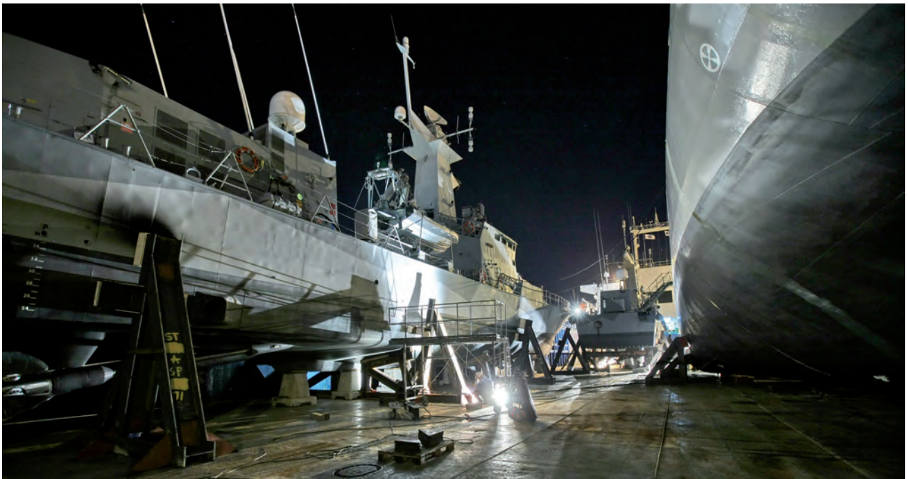
Korvetterna har dockat in och stöttorna svetsas fast i fartygsdäcket. Foto: Ingmar Elofsson.
