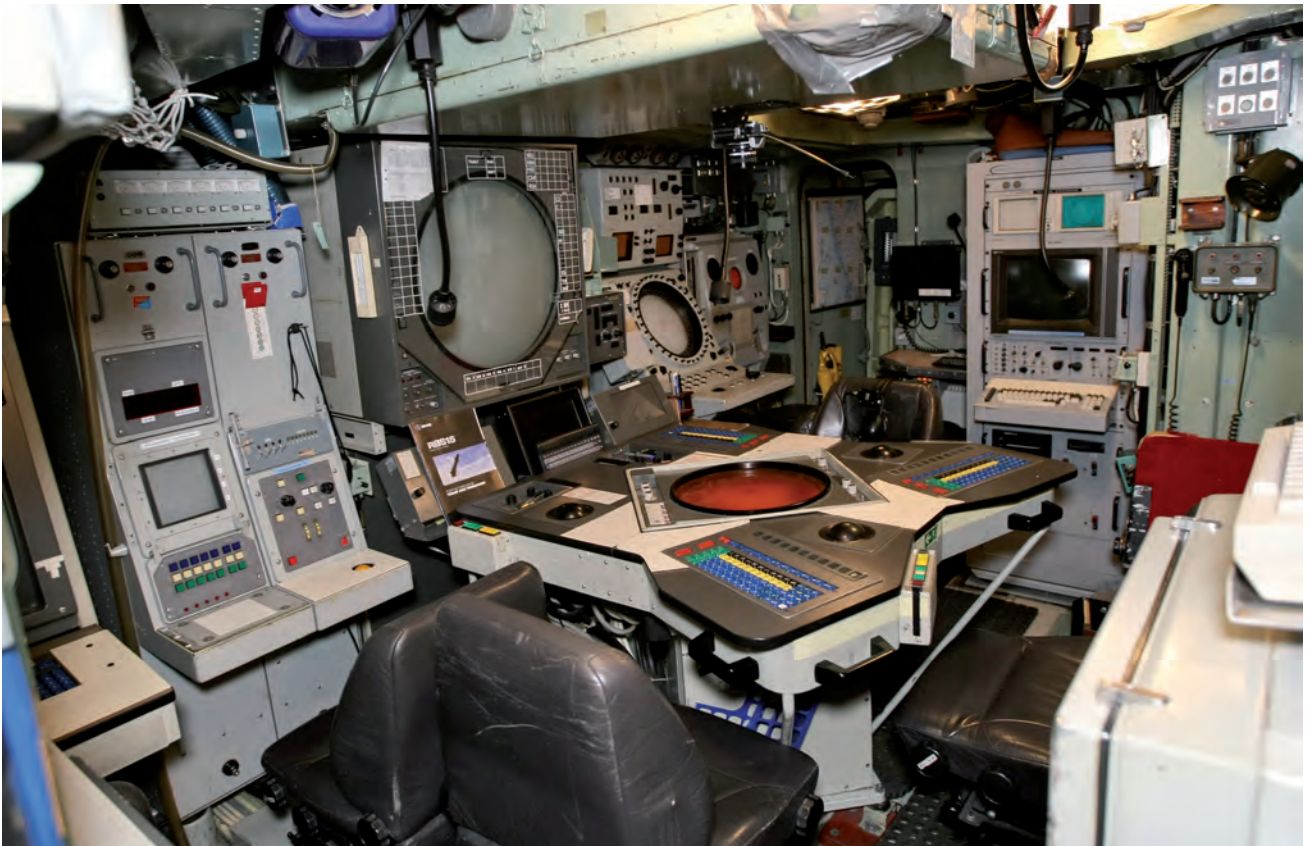
Stridsledningscentralen (SLC) ombord på Västervik. Vid panelen om styrbord (till vänster i bild) satt vapenofficeren (VapO) med ansvar för robotarna ombord. Vid det stora bordet, kallat SLI (Stridledningsindikator), satt stridsledningsofficeren (SLO) om BB, en värnpliktig SLI-operatör om SB och fartygschefen (FC) i centerlinjen. Om babord mot det aktra skottet satt artilleriofficeren (AO). Panelen som är vänd mot babordsidan är SIS-indikatorn som bemannades av en värnpliktig SIS-operatör.
