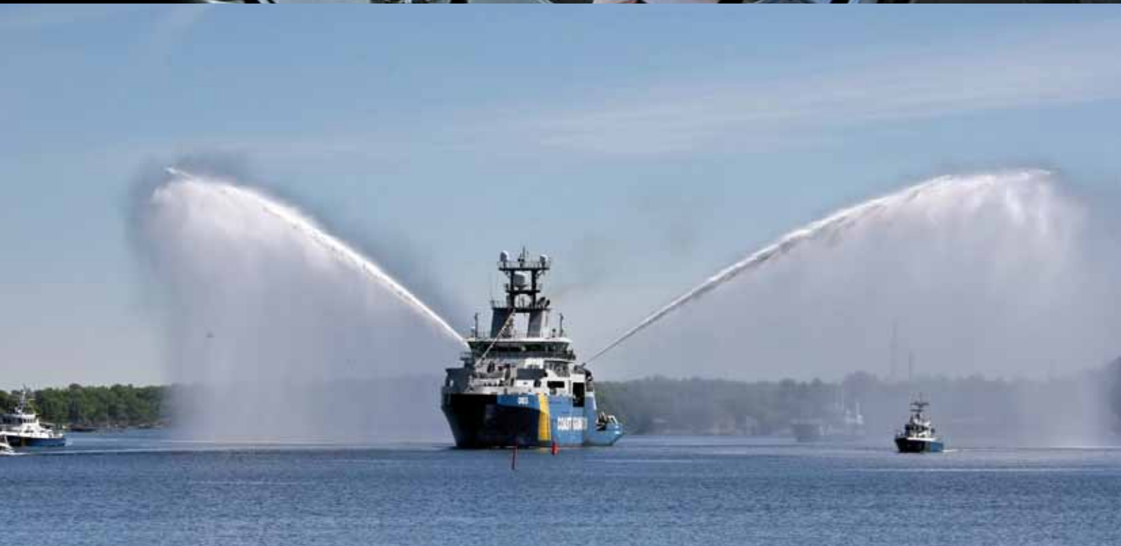
Kustbevakningens fartyg i Triton-klass är utrustade med vattenkanoner för bl.a. brandbekämpning. De är placerade på akterkant av och styrs från den aktra delen av manöverbryggan. De bägge vattenkanonerna når ut upp till 100 meter från styrbords- respektive babordssidan och ca sju ton vatten är i luften samtidigt. På övre bilden provkör chiefen Niclas Fagerström vattenkanonerna. Foto: Ingmar Elofsson.
