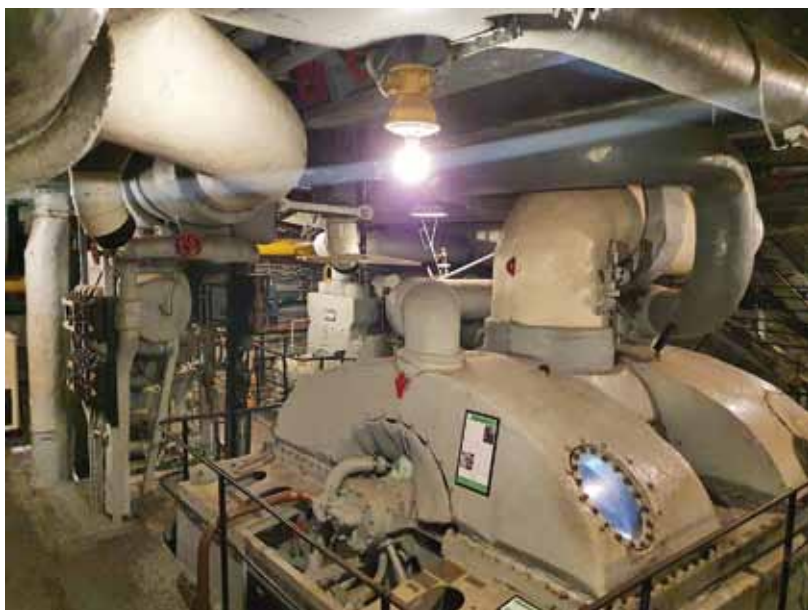
En av Alabamas åtta turbiner på sammanlagt 130 000 hkr vilka drev de fyra propellrarna.
