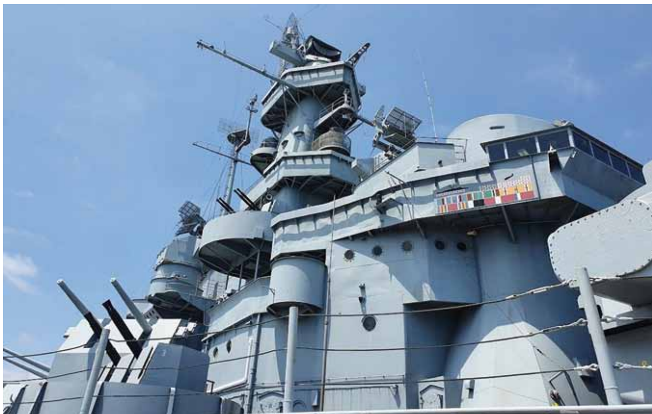
Dubbeltolvorna, samma kaliber som på våra jagare, flankerade av Bofors fyrdubbel 40 mm automatkanon (akan).
