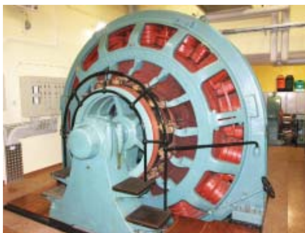
En jättegenerator som på sin tid brukades vid Stockholms Spårvägar
