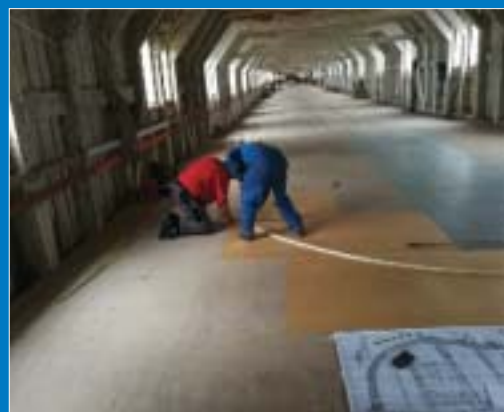
Utslagning av mallar till spantar. Kockums tidigare konstruktionschef och tidigare produktionschef, Sven-Erik Hellbratt respektive Bo Lindahl arbetar här med helt andra metoder, än de var vana vid i sin tidigare verksamhet
