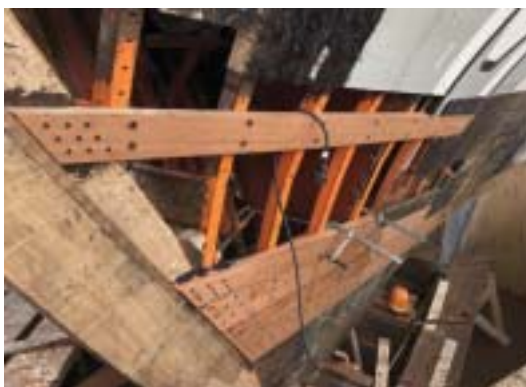
Förskeppet under renovering. Ny stäv, nya bord, reparerade spant och laskbrickor.
