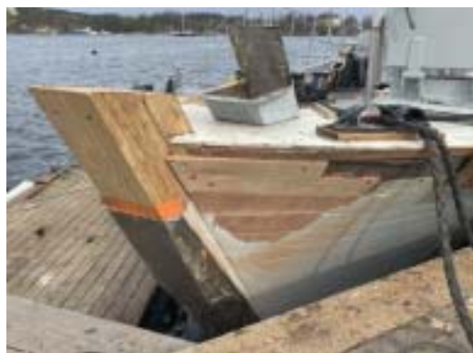
Förskeppet under renovering. Ny stäv, nya bord, reparerade spant och laskbrickor.
