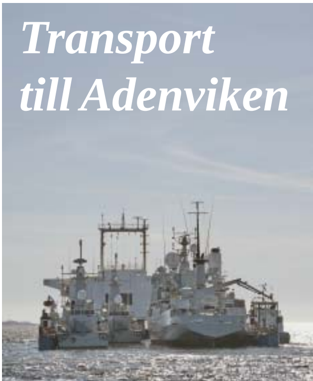
Fartygen har bogseras in i Eide Trader och hon fungerar i princip som en flytdocka. Foto Ingmar Elofsson
