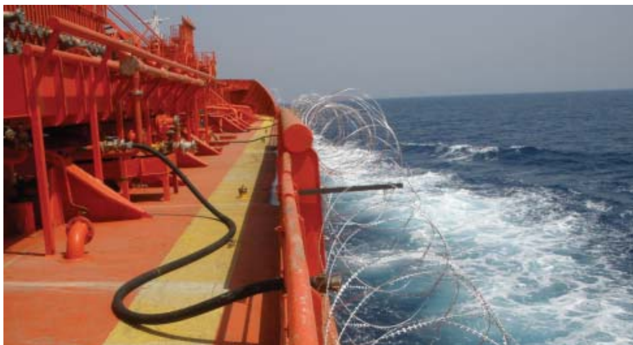
Passivt skydd med taggtråd och vattenslangar
