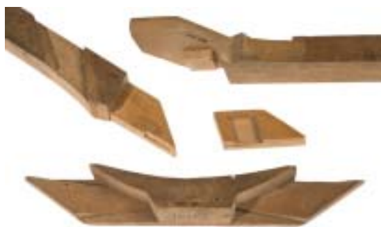
Detaljer som visar den komplicerade sammansättningen av spanthalvorna vid kölstocken
