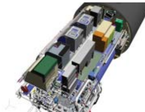
Stirlingavdelning inklusive ny skrovsektion och snitt nederst i bild. Copyright Saab AB
