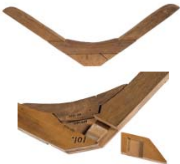
Modell av ett spants sammansättning vid kölstocken
