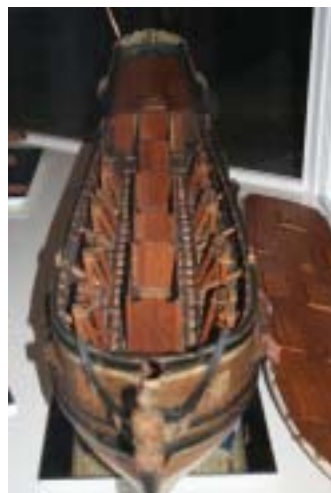
Bestyckningspråm, som använts för att visa kanonernas placering ombord
