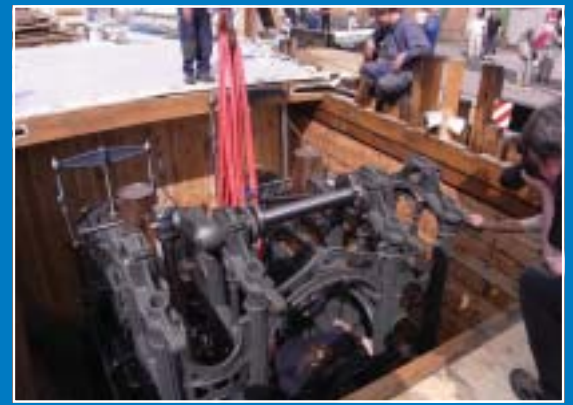
Ångmaskinen lyfts ombord i Motala.
