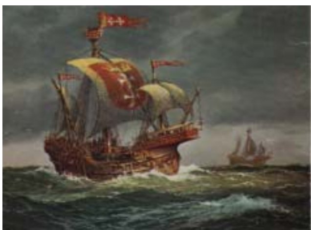
Kravellen var en av 1400-talets viktiga fartygstyper. Plan-korna låg kant i kant och därmed kunde man bygga större fartyg.
