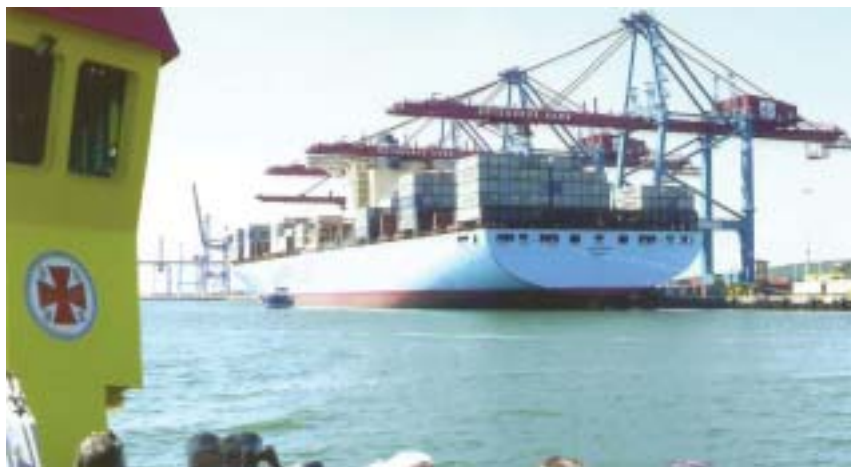
I Göteborgs hamn passerade vi Ebba Maersk, som med fyra kranar lossar cirka 17 000 containrar i rask takt. Fartyget är ett av de största containerfartyg som byggts. Ebba Maersk är 397 meter långt, 56 meter brett, har ett djupgående på 14 meter och ett displacement på 157 000 ton.
