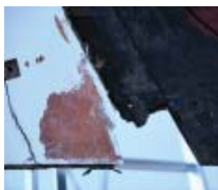
Rötskada akterstäv. Foto Marinstaben
