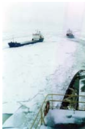
Atle kör ett par svängar runt fartyget Nordic för att minska isen våldsamma tryck mot skrovet
