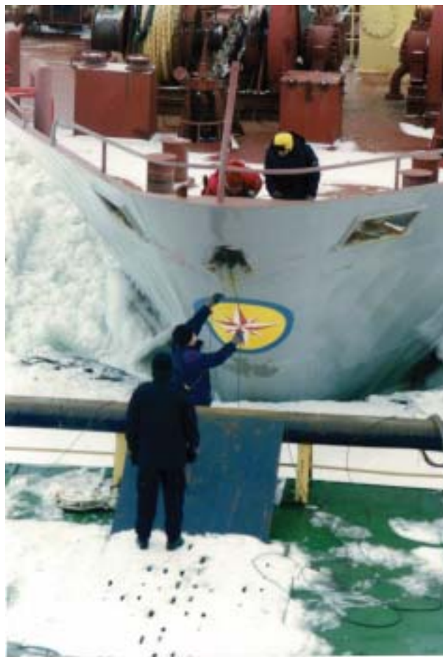
Flera wirar dras över till den fastnade Ek Cloud och snart sitter stäven säkert i isbrytarens ”klyka” längst akterut
