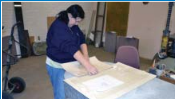
Lotta Björn lägger på den utskurna texten på stenen före blästring (djupblästring). Bild 6, stenen blästras i blästerkammaren av Jörgen Ringdal.
