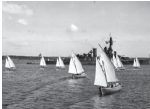
Kappsegling med valbåtar. I bakgrunden Drottning Victoria. Valbåtarna var spetsgattade och hade ketch tackling med stormast och jäckmast, stagflock samt storsegel och mesan (jäckan). Båda var loggertsegel.
