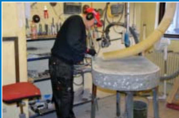
Bernt Trulsson gradhugger framsidan före textningen, vilket betyder att framsidan blir ljusare.
