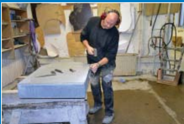
Lasse Forsell formar stenens sidor till önskat mått.
